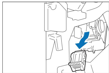
65枚ステープルユニットでは、レバーを下方向に倒して、ホチキスカートリッジを取り出します。
