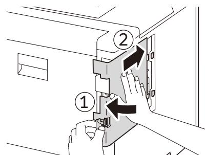
7. ラッチを本機の前方向に倒してから左にスライドさせ、カバーをロックします。
