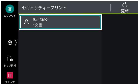
3. プリンタードライバーで指定したパスワードを入力して、[OK] をタップします。
