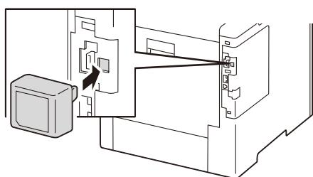
5. 電源コードをコンセントと本機に接続し、〈電源 / 節電〉ボタンを押して、電源を入れます。
