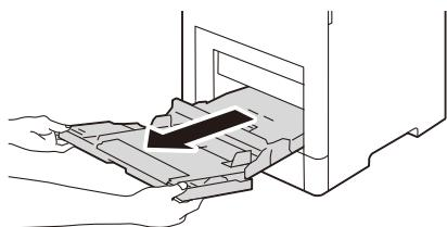
5. 水でぬらして固く絞った柔らかい布で、手差しトレイと本体の手前にある給紙ローラーのゴム表面を、やさしく、押し付けないように拭きます。
