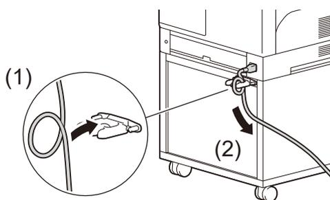
13. 電源コードのもう片方を、コンセントに差し込みます。
