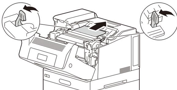
3. 内部に破れた紙片が残っていないかを確認し、レバーを戻します。
