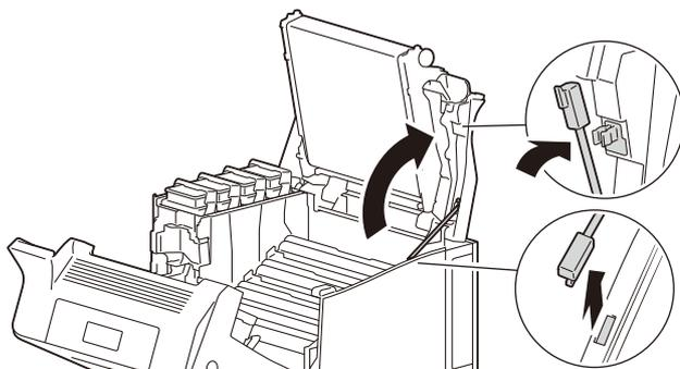
**12.** トップカバーを静かに手前に倒したあと、カバー中央部を上から押して閉じます。
