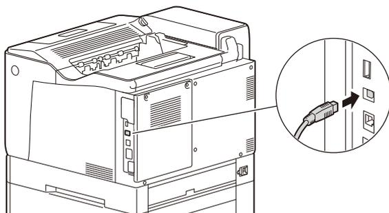
3. USB ケーブルの他方のコネクタを、コンピューターに接続します。
