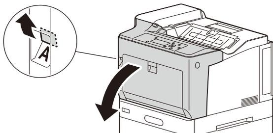
2. 図の位置にあるレバーを押し下げ、詰まった用紙がある場合は取り除き、内部に破れた紙片が残っていないかを確認し、レバーを戻します。
