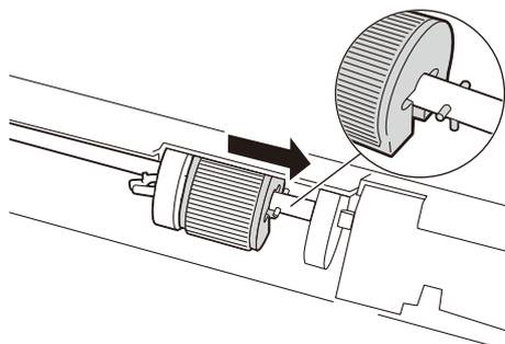
10. ストッパーを右にずらして用紙搬送ロールに寄せ（1）、ストッパーのツメを軸の溝にはめます（2）。
