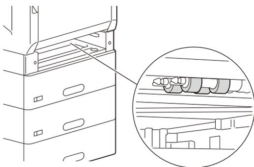
6. 手前の用紙搬送ロールのツメを広げてロックを外し (1)、軸から引き抜きます (2)。
