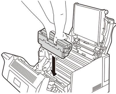
9. 残りのドラムカートリッジをシアン (C)、マゼンタ (M)、イエロー (Y) の順に手順6～8に従って取り外し、ガラス面を清掃後に元に戻します。ドラムカートリッジの各色の位置は、図を参照してください。
