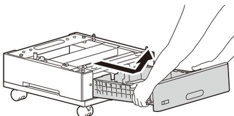
**7.** 本機に付属の4つのネジを、トレイモジュールの内側にある4つの穴に差し込んでしっかり締め、トレイモジュールを専用キャスター台に固定します。
