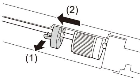
**6.** 用紙搬送ロールをストッパーのところまで左にずらしてから、手前に 90° 回転させて引き抜きます。
