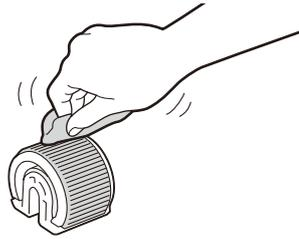
8. 清掃後、用紙搬送ロールの側面が平らになっているほうを右側にして、水平に軸に押し込みます。
