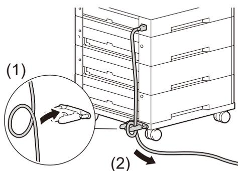
14. 電源コードのもう片方を、コンセントに差し込みます。
