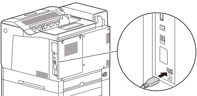
3. ネットワークケーブルの他方のコネクタを、ハブなどのネットワーク機器に接続します。
