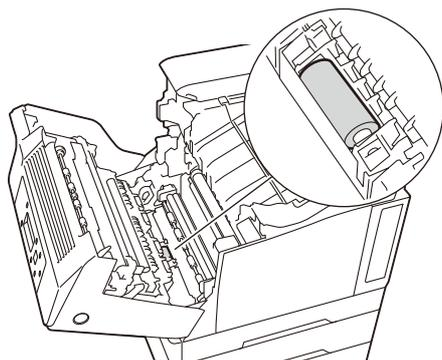
4. 水でぬらして固く絞った柔らかい布で、用紙搬送ロールを回転させながら、ゴム製の部分を拭きます。
