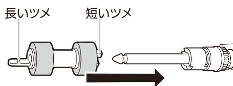
10. 用紙搬送ロールの短いツメを軸の溝に合わせて、しっかり奥まで押し込みます。
