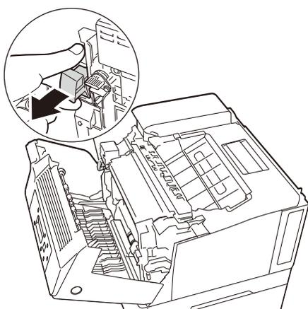
**5.** 用紙搬送ロールのストッパーを回転させてツメを手前側にし、ツメを広げてロックを外します (1)。ストッパーだけを左に止まるまでずらします (2)。
