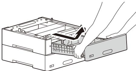
7. トレイモジュールに付属のネジ 4 本を、上のトレイモジュールの内側にある 4 つの穴に差し込み、コインなどでしっかり締め、上のトレイモジュールを下のトレイモジュールに固定します。
