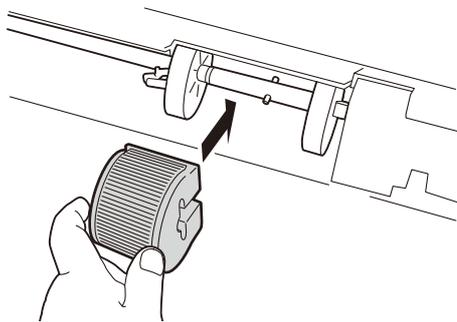
9. 用紙搬送ロールの凹部（溝）に軸のピンがはまるように、用紙搬送ロールを奥側に90°回転させ、右にずらします。
